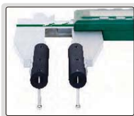
测量孔内凹槽直径 (凹槽深度 h_2 \leq 7\text{mm} )
